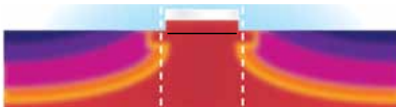
Kuva 3: Tasalämpöisen kanavan muodostaminen nollalämpövuotekniikalla
